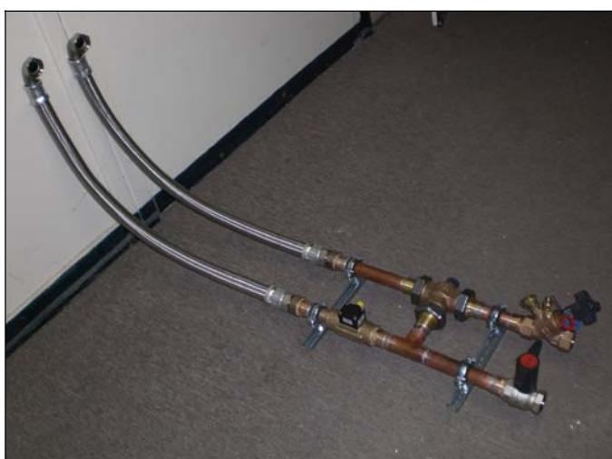
Рисунок CoolLoop, набор внешних клапанов
